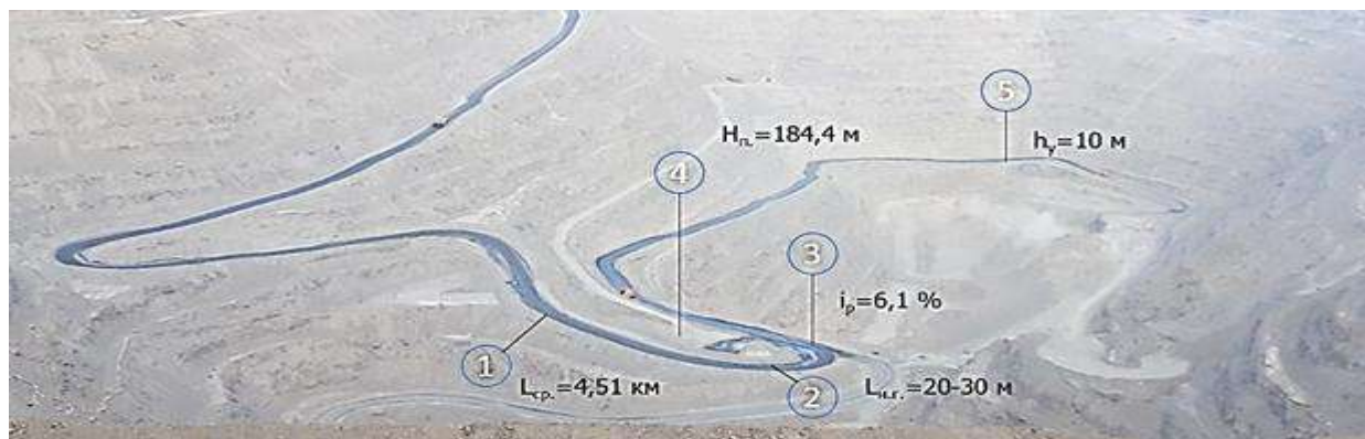
3-rasm chuqur karerlarni ishlab chiqish vaqtida kon massasini tashishning rejada va chuqurligi bo'yicha maqbul texnologik sxemasi
