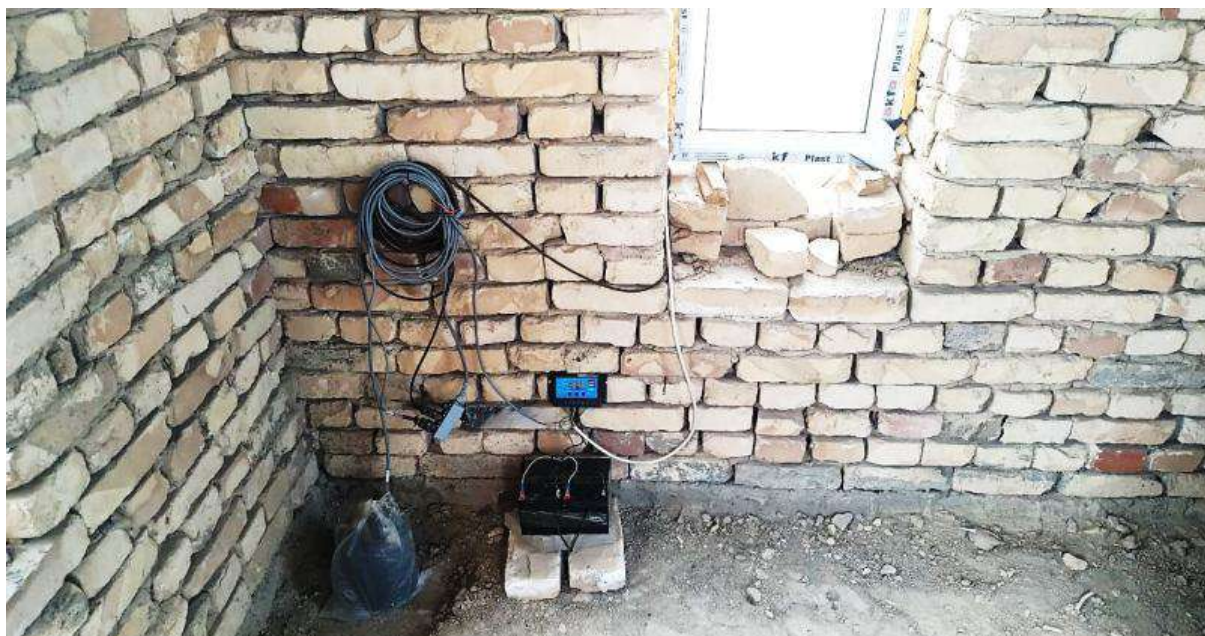
2-rasm. Tesha Mirzayev qishlog'ida o'rnatilgan tayanch seysmik stantsiya (Stantsiya №1)
