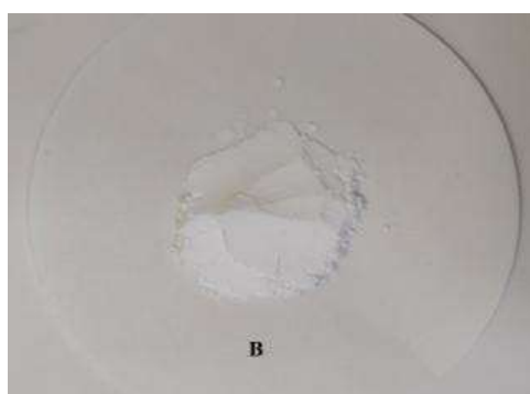
2-rasm. a) 650°C haroratda qizdirib olingan metakaolin b) \gamma-Al_2O_3
