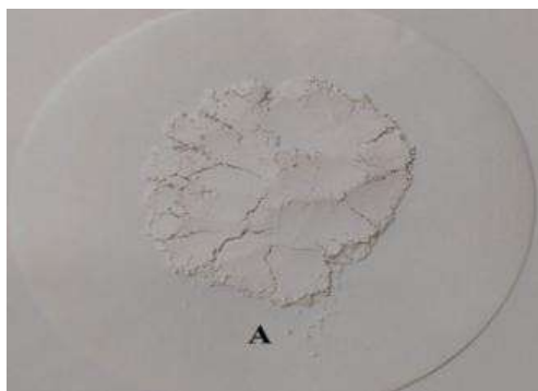
2-rasm. a) 650°C haroratda qizdirib olingan metakaolin b) \gamma-Al_2O_3
